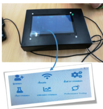
กล่องควบคุม หน้าจอตชสีกรีน และหน้าจอเมนู และระบบ FSN Perf XXXXXXXXXXXX XXXX
