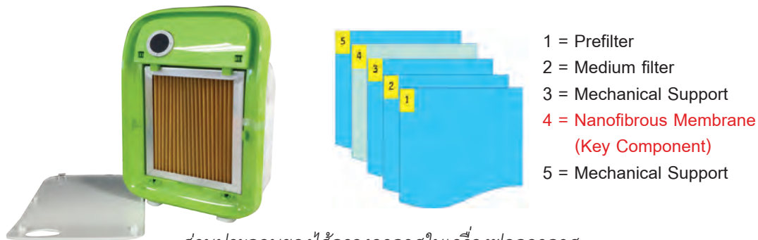
ส่วนประกอบของไส้กรองอากาศในเครื่องฟอกอากาศที่มีแผ่นกรองนาโนสมบัติพิเศษ 'n-Breeze'
