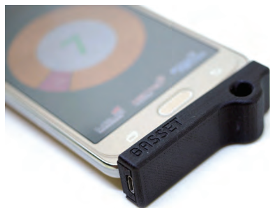
การใช้งานผลิตภัณฑ์ ในอุปกรณ์ตรวจวัดปริมาณแก๊ส แบบต่อพ่วงแสดงผลบนสมาร์ทโฟน
